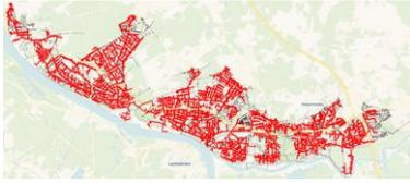
Abbildung 83: Netzausbauszenarien Netzgebiet Nord für verschiedene Grenzwerte der Wärmelinendichte von 750 bis 3 500 kWh/(m-a).
